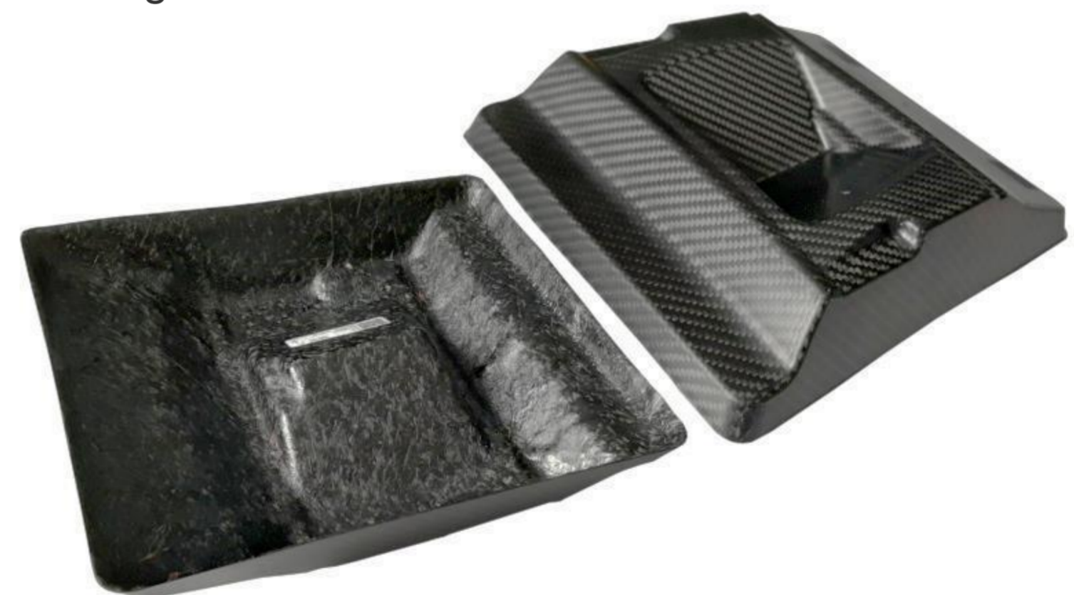
Abbildung: Sichtcarbonbauteil aus Gewebeprepreg mit Bagging-Lagen aus rSMC
