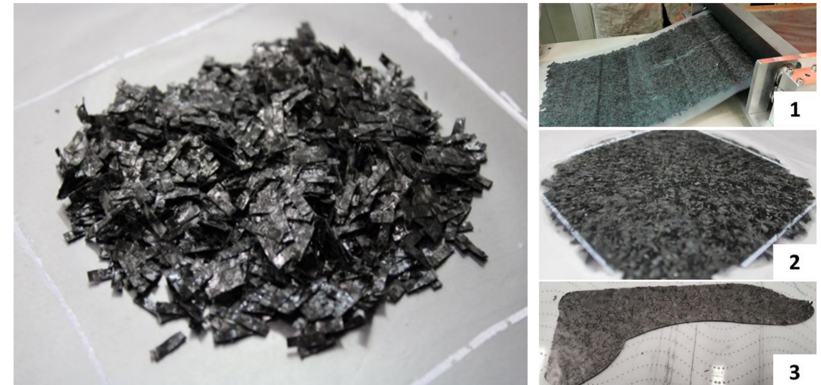
Abbildung: (links) geschnittene, unkonsolidierte Faserschnipsel; (rechts) konsolidiertes Halbzeug aus rSMC als (1) Rollenbahn, (2) Patch und (3) bauteilnaher Zuschnitt
